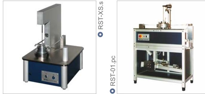
Das kleine Ringschergerät RST-XS.s arbeitet mit Scherzellen im Bereich von 3.5 cm<sup>3</sup> bis 70 cm<sup>3</sup> Probevolumen. Für das große Ringschergerät RST-01.pc sind Scherzellen bis zu 900 cm<sup>3</sup> Probevolumen verfügbar so dass Partikel bis zu 10 mm (Wert ist abhängig von der Partikelgrößenverteilung) untersucht werden können.
